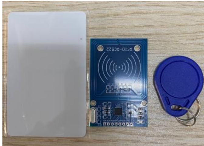
Fig.2 RC522 RF Module
